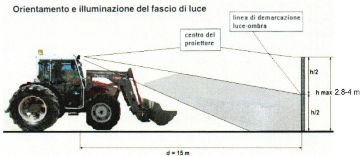
Figura 1 – Orientamento del fascio di luce per fari con altezza del centro ottico “h” superiore a 1,5 m e inferiore a 4,0 m
